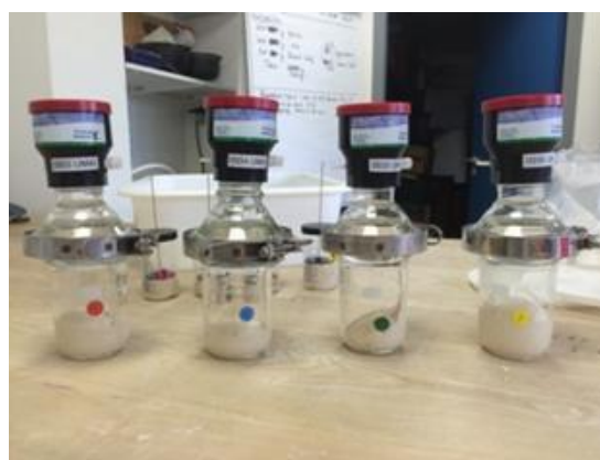
Figure 23 : Mesure de la production gazeuse apparente des pâtes (Système Ankom)
