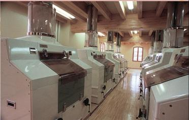
**Mouture par fractionnement sur appareils à cylindres**
