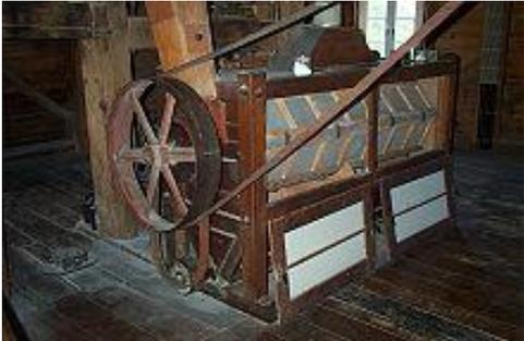
Le plansichter (machine à tamiser avec des tamis plans)
